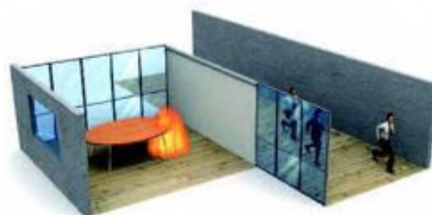
Skyddar emot brandspridning från ett rum till korridor.
