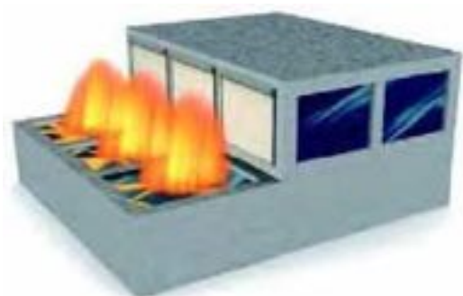
Skyddar emot utvärdig brandspridning mellan våningar.
